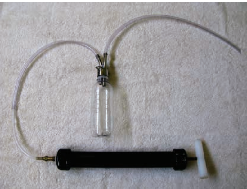
Exemplo de bomba de sucção manual acoplada a um recipiente de coleta PET/500 ml.
