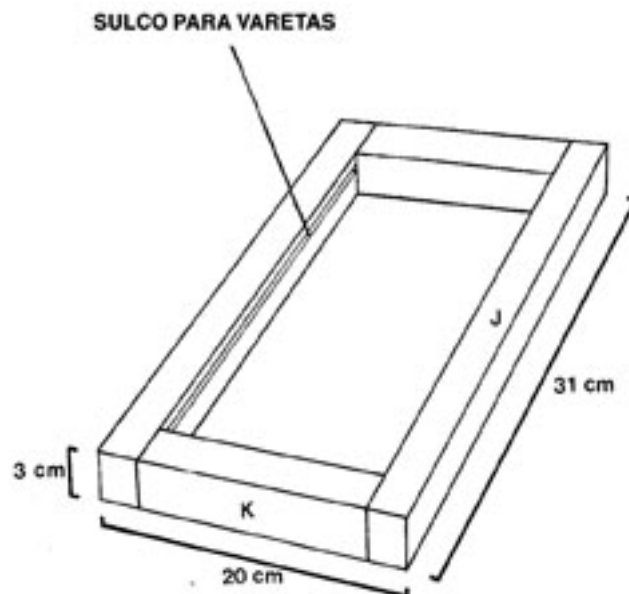
Fig. 13 - C - Os quadros de aumento servem para ser colocados sobre as gavetas, nas colmeias PNN de tamanho mediano. Isso é necessário quando se trata de receber uma espécie que constrói potes de alimento grandes ou médios (Desenho de France Martin Pedreira).
