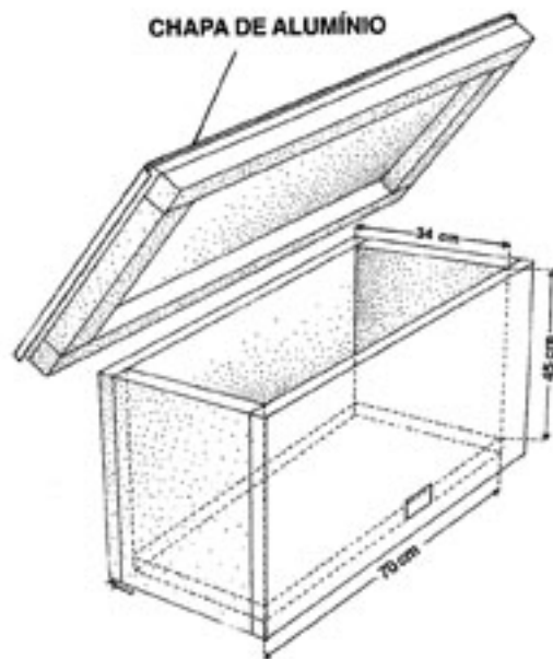
Fig. 11 - K - Caixa de proteção, dentro da qual uma colmeia fica envolta por serragem seca, exceto em baixo. A serragem seca até certo ponto protege a colônia do frio, conservando o calor produzido no ninho (Desenho de France Martin Pedreira).
